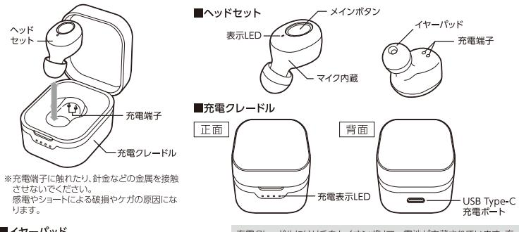
※充電端子に触れたり、針金などの金属を接触させないでください。感電やショートによる破損やケガの原因になります。
