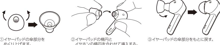
ご注意 ※装着感向上のためイヤーパッドの取付部がきついに設計されています。取り付け時は双方をしっかりと保持し挿入してください。
