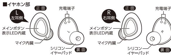
\*内蔵のマイクはR側/L側イヤホンそれぞれに搭載されていますが、ご使用時にはスマートフォンと直接接続した親機側イヤホンのマイクのみが機能します。
