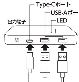
青LEDが点灯していることを確認し、Type-Cポート、USB-Aポートに充電対象機器に対応したケーブルのコネクタを接続します。
