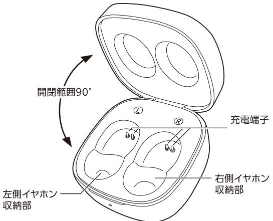
※充電端子に触れたり、針金などの金属を接触させないでください。感電やショートによる破損やケガの原因になります。
