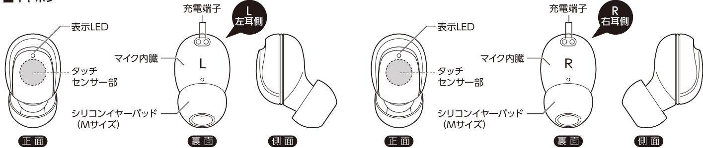
※内蔵のマイクはR側/L側イヤホンそれぞれに搭載されていますが、ご使用時にはスマートフォンと直接接続した親機側イヤホンのマイクのみが機能します。
