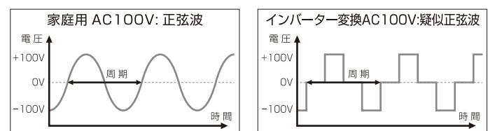
家庭用AC100Vの出力波形と、インバーターが変換したAC100Vの出力波形は、上記のように違います。出力波形の違いにより、位相制御を利用した機器などは本製品で使用できません。例、マイコンを使用している機器：計測機器・電子ポット・調光器など。
