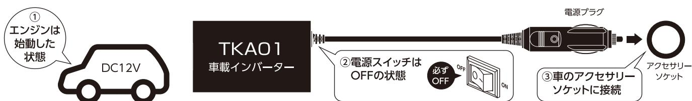
**!** 本製品や接続機器が電源ONの状態で車のアクセサリーソケットに接続されている時は、エンジンを停止したり始動したりしないでください。
