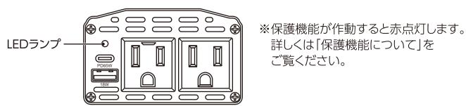
③接続する機器の電源スイッチがOFFの状態になっていることを確認し、本製品のACコンセントに使用する機器のACプラグを接続してください。
