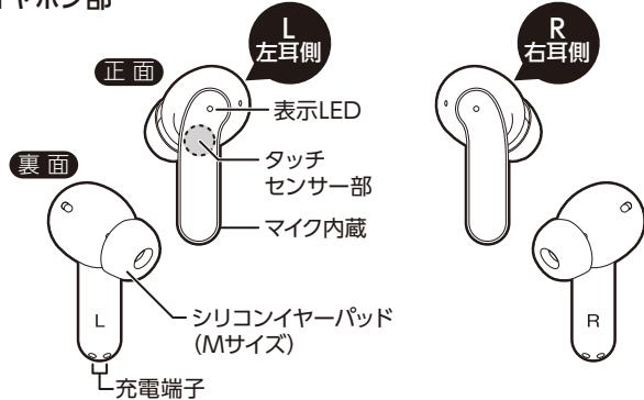
※本製品のマイクはR側/L側イヤホンにそれぞれに搭載されていますが、ご使用時にはスマートフォンと直接接続した親機側イヤホンのマイクのみが機能します。
