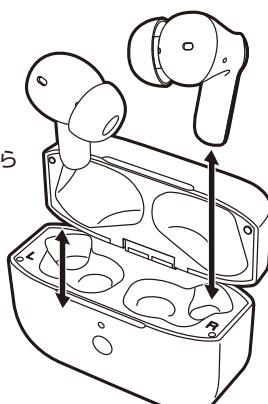
③イヤホンがペアリングモードになると、親機側に設定されたイヤホンの表示LEDは早い白点滅し、子機側に設定されたイヤホンの表示LEDは約2秒間隔で白点滅します。
