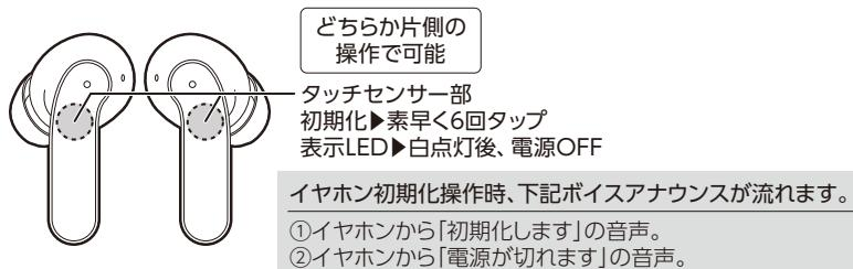
③イヤホンを充電済みの充電クレードルに収納し、【3.スマートフォンとのペアリング・接続】の手順に従い、再度スマートフォンとのペアリング・接続操作をおこなってください。※初期化後、ペアリング・接続操作をおこなう際には必ず、左右のイヤホンを充電クレードルから取り出してください。
