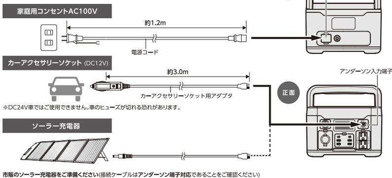
**パススルー機能** 本製品を充電しながら同時に接続されたデバイス・小型家電へ給電が可能です。停電時は無停電電源装置としてご使用可能です。
