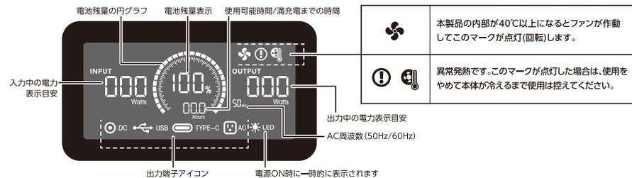
各出力ボタン (DC) (USB) (AC) を押すと点灯/消灯します。各端子が異常 (過電流、ショートなど) を感知するとエラーコードを表示し、その出力端子アイコンが点滅します。接続したケーブルをすべて取りはずし、再度点滅している出力ボタンを押すと点滅が解除されます。
